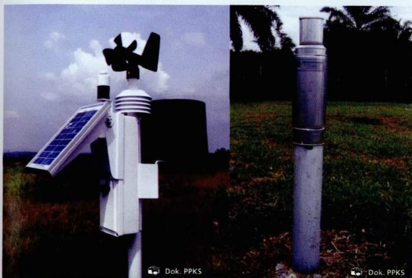
Automatic Weather Station (kiri), dan tabung penakar curah hujan (kanan) merupakan alat untuk mengetahui kondisi klimatologi pada areal perkebunan kelapa sawit.
