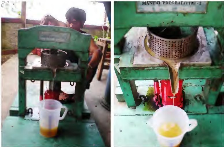
Gambar 14. Pengepresan biji menggunakan dongkrak hidrolik manual
