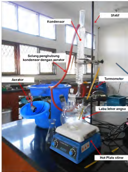
Gambar 24. Rangkaian peralatan pembuatan biodiesel skala laboratorium
