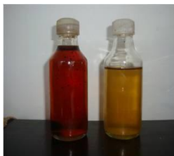
Gambar 1. Deorub pembeku lateks dan Lateks yang telah dibekukan dengan deorub
