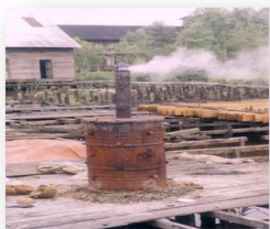
Gambar 3. Alat pengolah arang tempurung dan arang tempurung berkualitas
