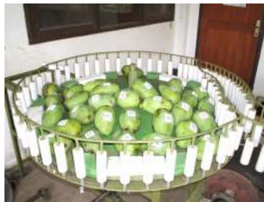
Gambar 1. Sketsa dan prototipe unit pengumpan berbentuk piringan kerucut berputar
