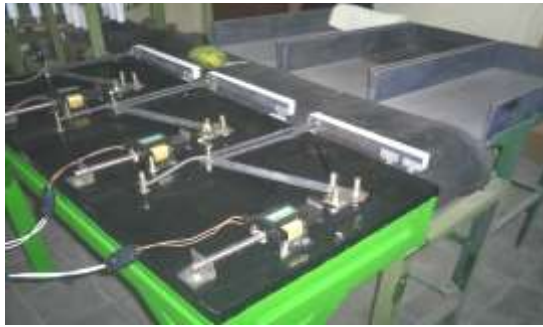
Gambar 2. Unit pemisah pada mesin sortasi mangga dengan Solenoid sebagai penggerak
