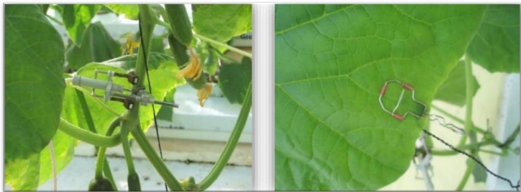
Gambar 3. Pengendalian irigasi greenhouse berbasis phyto-sensing menggunakan perangkat sensor batang dan daun tanaman (sumber : Nikolaou et al. 2019)
