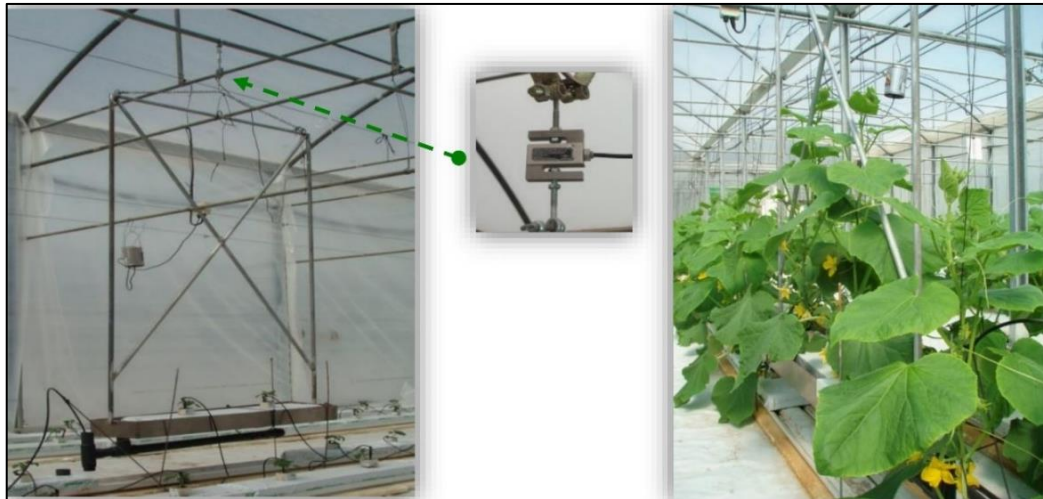
Gambar 2. Pengendalian irigasi greenhouse berbasis pemantauan iklim mikro menggunakan perangkat lysimeter (sumber : Nikolaou et al. 2019)
