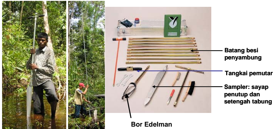
Gambar 1. (Kiri) bor gambut sebelum disambung dengan extension rod (tiang sambungan) untuk mengambil contoh gambut dengan kedalaman 0-50 dan 50-100 cm; (Tengah) bor gambut dengan beberapa tiang penyambung untuk mengambil contoh pada kedalaman beberapa meter; dan (Kanan) komponen dari bor gambut yang terdiri dari tangkai pemutar, tiang sambungan dan sampler.
