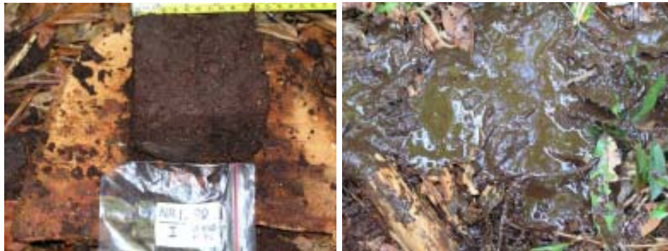
Gambar 8. (Kiri) contoh gambut berbentuk kubus dan (Kanan) contoh gambut yang mencair yang diambil dengan bor Eldeman karena berasal dari kedalaman di bawah muka air tanah.
