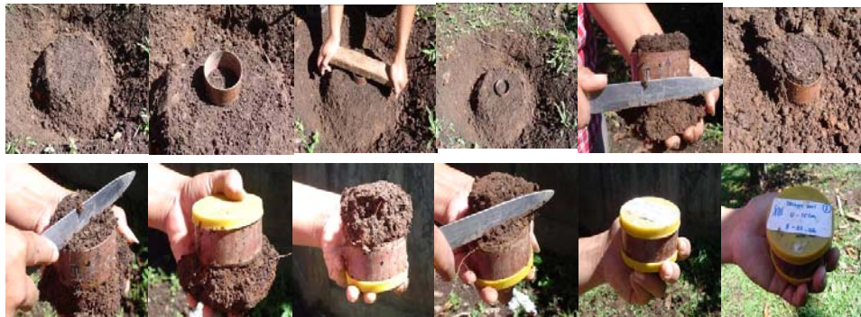
Gambar 7. Tahapan pengambilan contoh tanah (gambut) utuh menggunakan ring kuning (dari pojok kiri atas ke pojok kanan bawah).
