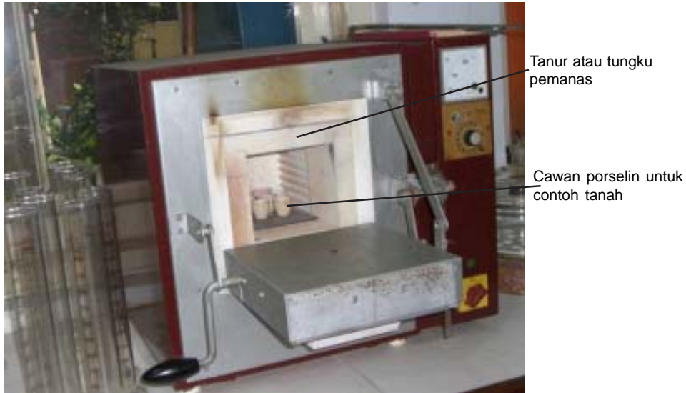
Gambar 10. Cawan porselin yang digunakan untuk pengabuan kering di dalam tanur (tungku pemanas/furnace).
