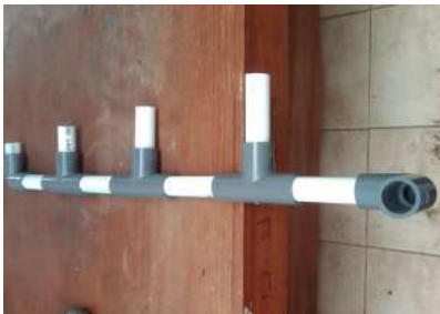
Pipa dari pompa dihubungkan ke setiap pangkal sistem pertanaman. Di bagian tengah ada kran untuk mengatur jumlah input air
