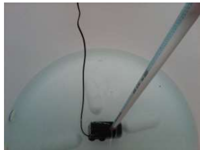
Pompa dihubungkan dengan pipa paralon \frac{3}{4} inci ditempatkan di tengah dasar kolam (tandon)
