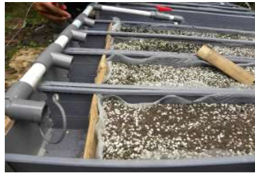
Campuran zeolit kecil dan kompos digunakan sebagai lapisan atas
