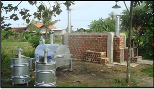
Gambar 1. Alat pembuat biochar ( pirolisator ): mobile (drum) dan permanen (Foto: Nurida)
