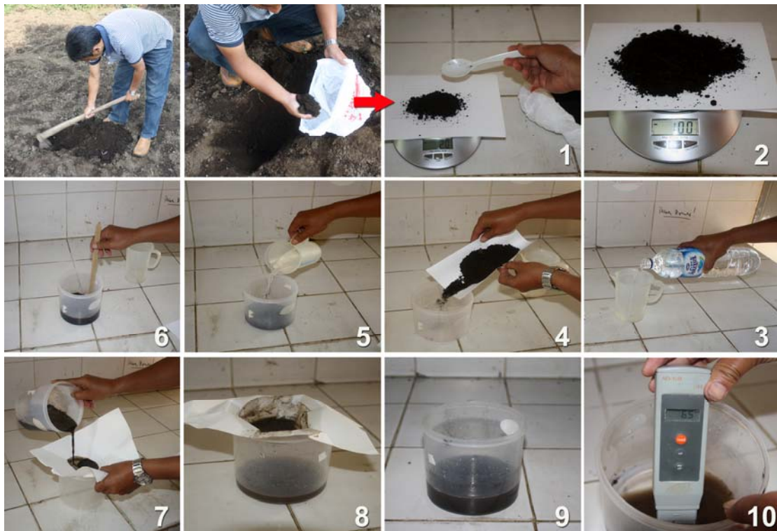
Gambar urutan pengukuran pH tanah menggunakan alat ukur pH digital
