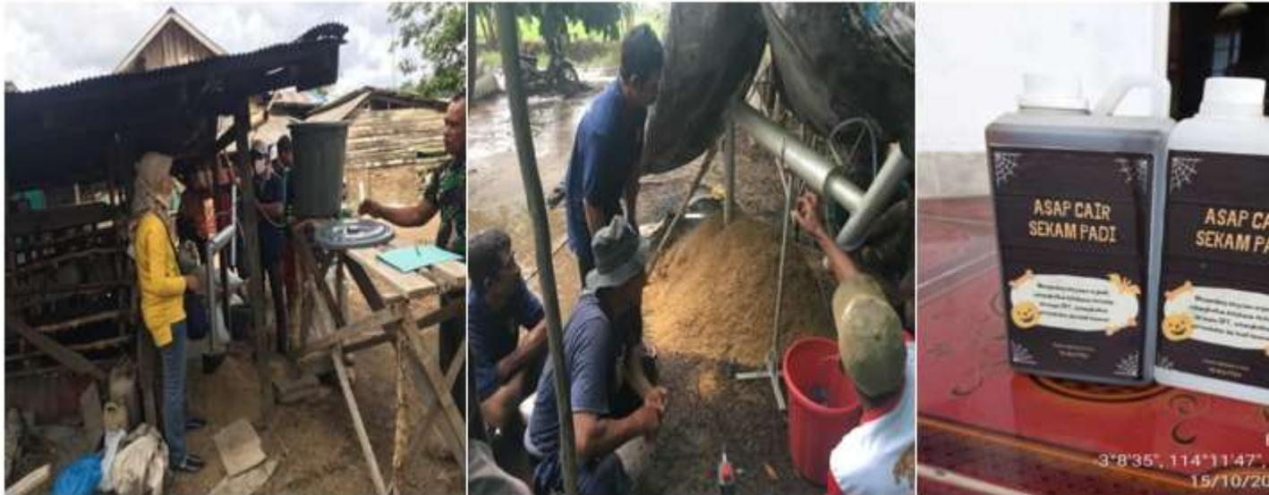
Gambar 2. Proses pembuatan biochar dan asap cair berbahan baku sekam padi
