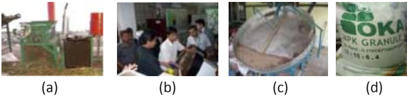
Gambar 4. (a) Penepungan bahan pupuk (kompos dan bahan pengkaya lainnya), (b) Pencampuran bahan dan persiapan bahan perekat, (c) Proses granulasi, (d) Pengemasan.
