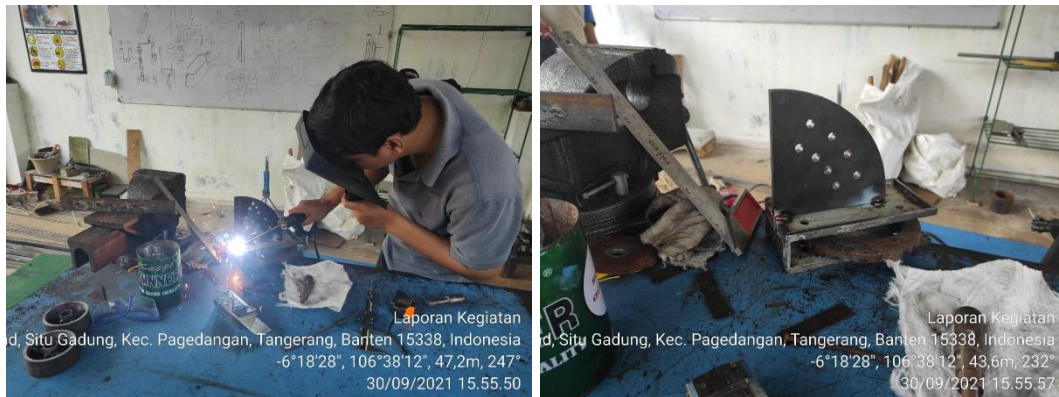
Gambar 4.4. Pengelasan plat penyetel sudut rotari pada rangka
