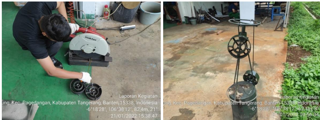
Gambar 4.62. Proses pembuatan roda penyangga dan penyetel kedalaman
