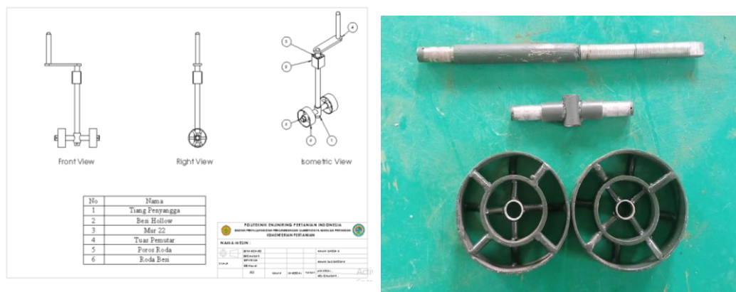
Gambar 4.13. Desain Roda Pengatur Kedalaman dan Hasil Manufaktur Komponen Roda Pengatur Kedalaman
