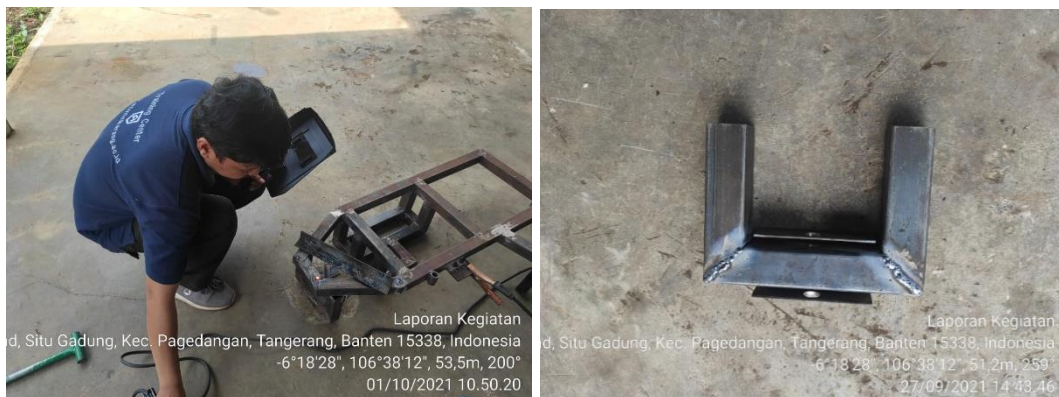
Gambar 4.6. Proses pengerjaan rangka utama dari baja ST37 hollow 40 x 60 mm
