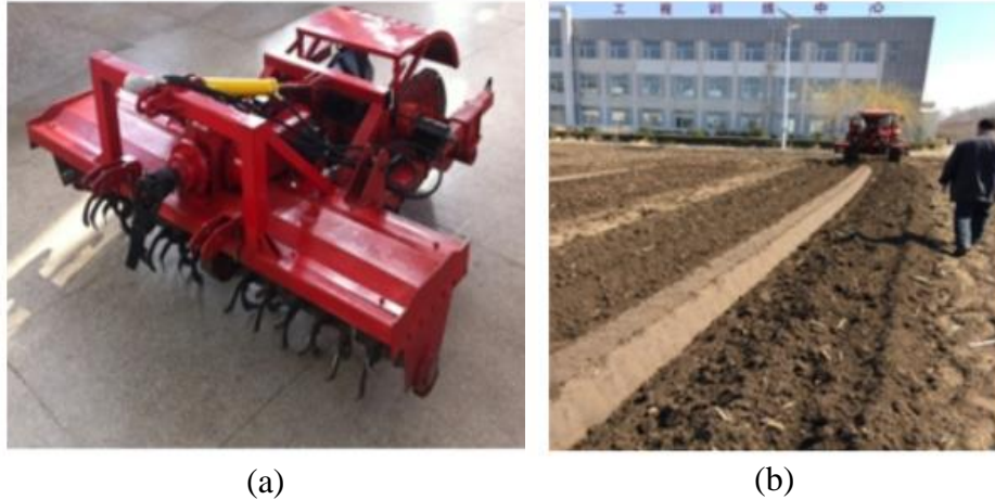
Gambar 2.1. (a) Implement pematang sawah, (b) Hasil pembuatan pematang menggunakan implement (Sumber : Farm Machinery )
