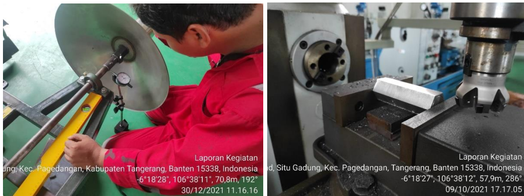
Gambar 4.17. Proses pengukuran alignment poros silinder dengan dial indikator (kiri), dan proses pembuatan poros segi enam (kanan).
