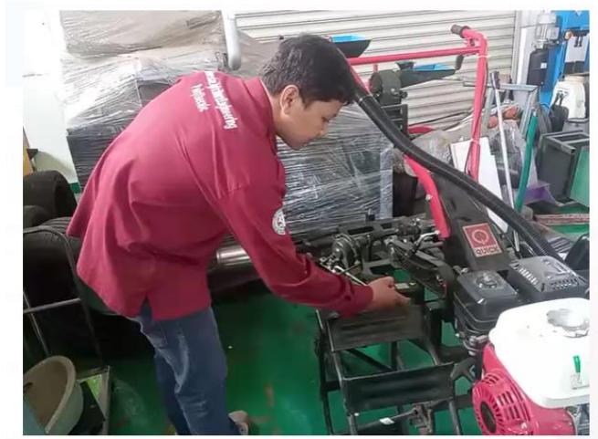
Gambar 4.21. Uji Fungsional Mesin Pembuat dan Pembelah Pematang Sawah
