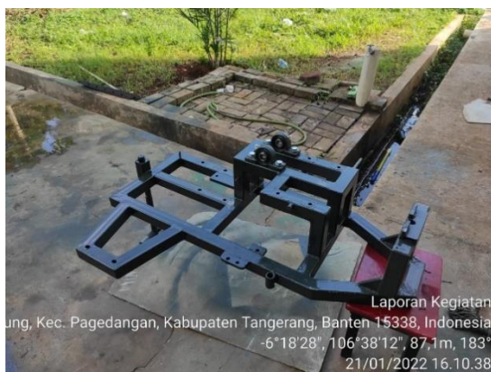
Gambar 4.8. Rangka utama implemen pematang sawah setelah dilakukan pengecatan
