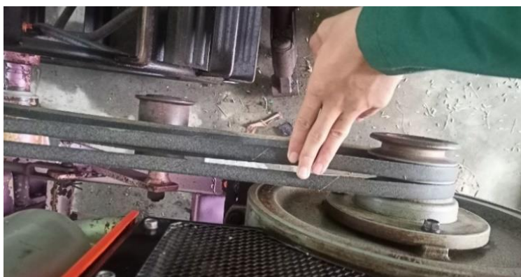
Gambar 11. pengecekan ketegangan V-belt
