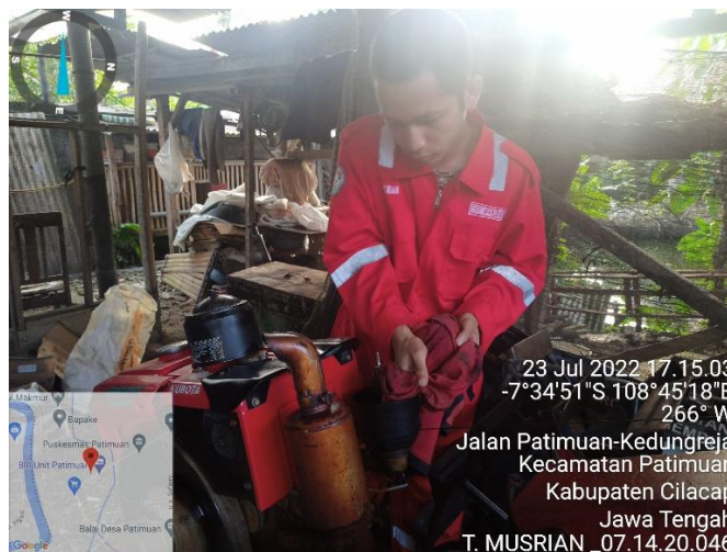
Gambar 8. Pembersihan Saringan Udara
