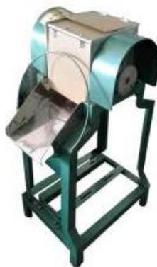
Gambar 2.5. Mesin Pamarut Kelapa
