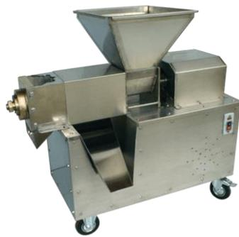
Gambar 2.6. Mesin Pemeras Kelapa
