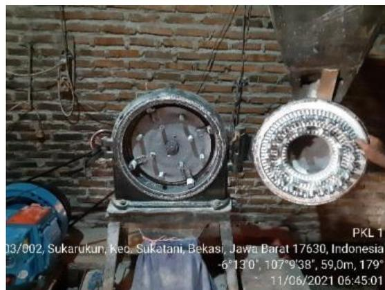
Gambar 4.23. Mesin Diskmill Tampak Dalam
