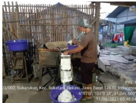
Gambar 4.7. Proses Pamarutan Kelapa
