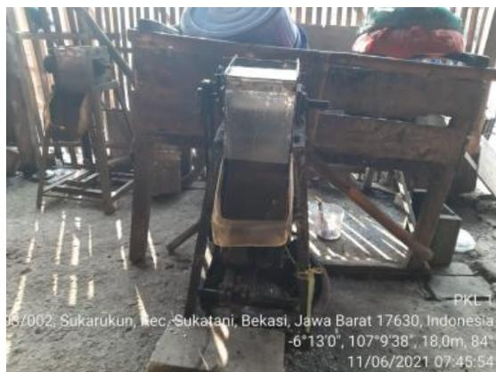
Gambar 4.22. Mesin Pamarut Kelapa
