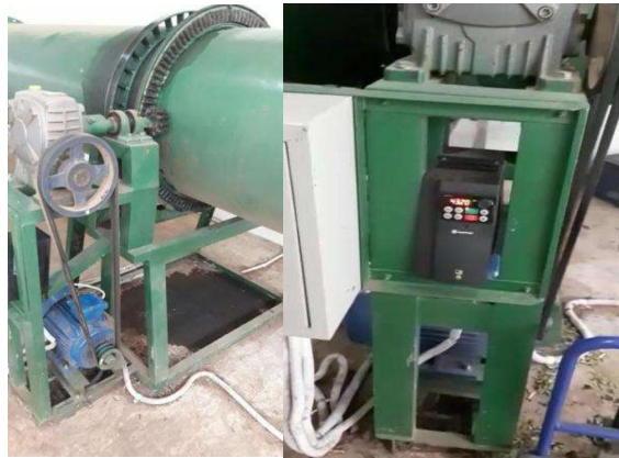
Gambar 3.7. Motor AC, gearbox dan inverter pengering rotari
