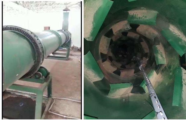
Gambar 3.6. Silinder (drum) pengering rotary dan flight
