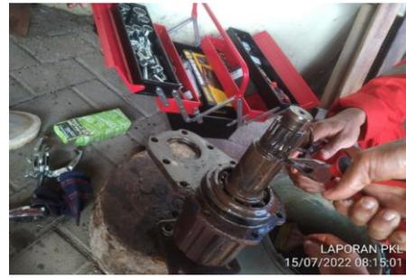
Gambar 11. Pembongkaran pada traktor roda dua.
