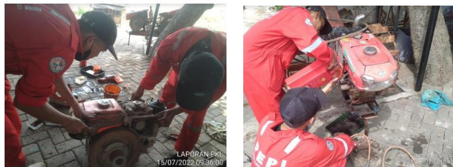
Gambar 10. Pembersihan mesin dan penggantian oli pada traktor roda dua.
