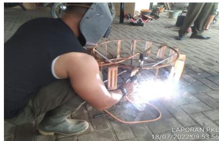
Gambar 12. Pengelasan pada roda sangkar traktor roda dua.
