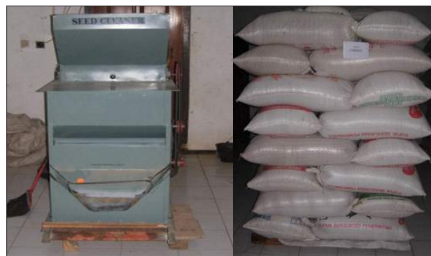
Gambar 7. Mesin pembersih gabah calon benih dan gabah hasil pembersihan
