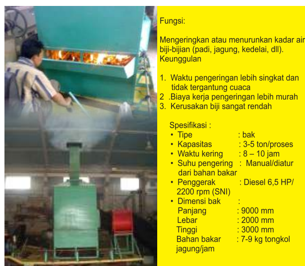
Gambar 5. Mesin pengering gabah dengan bahan bakar tongkol jagung (Suparlan, 2014)
