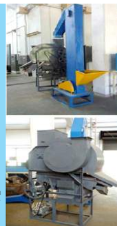
Gambar 8. Mesin pembersih gabah double blower (BB Mektan, 2015b)
