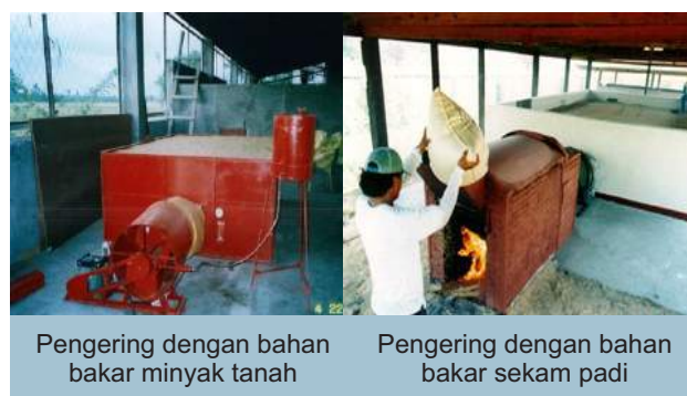
Gambar 4. Pengering tipe bak dengan bahan bakar minyak tanah dan sekam padi (Suparlan,
