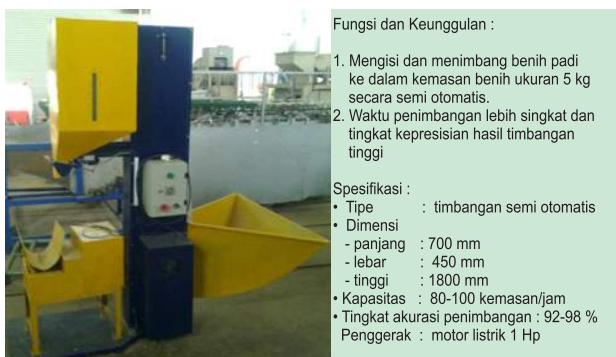
Gambar 9. Mesin penimbang benih padi tipe semi otomatis (Balitbangtan, 2013)
