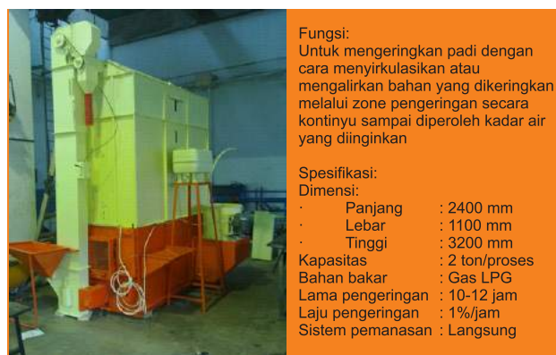
Gambar 6. Mesin pengering gabah tipe sirkulasi (Balitbangtan, 2013)
