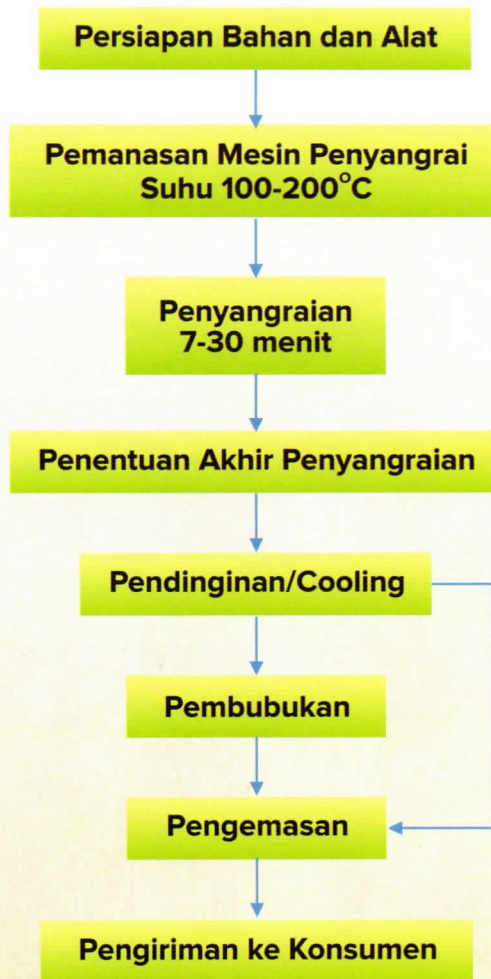
Gambar 4.8. Bagan alir proses pengolahan sekunder
