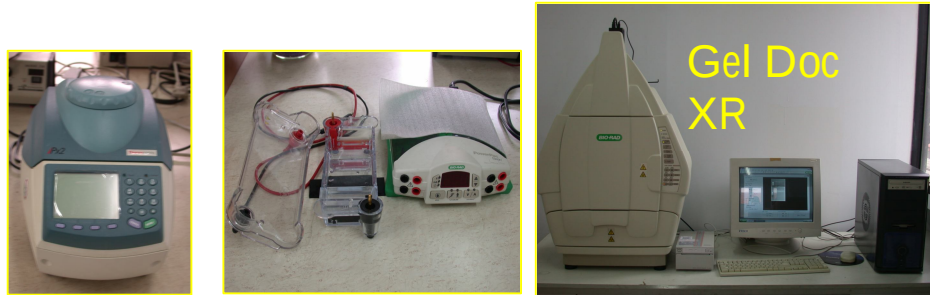
Gambar 10. Alat-alat yang diperlukan pada metode molekuler (dari kiri ke kanan) : mesin PCR, satu set elektroforesis, dan alat untuk dokumentasi hasil (Geldoc) (Foto: Koleksi BBUSKP,2006)
