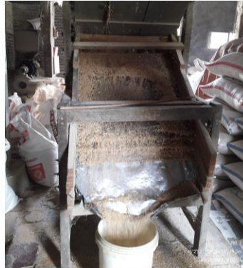
Gambar 14. Mesin pemisahan Gabah dan Beras Pecah Kulit
