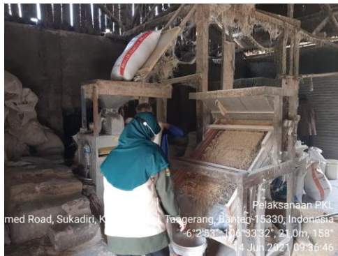
Proses tahap pengayakan dan proses tahap pemolesan beras.
