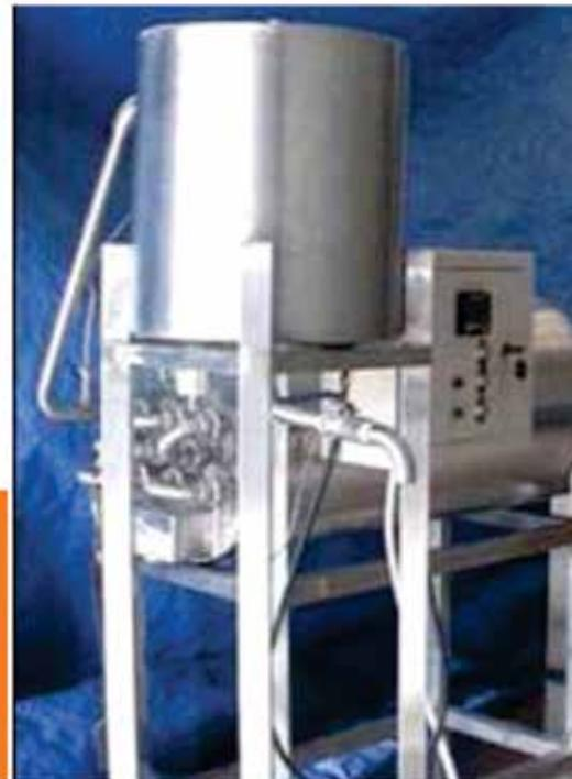
Pasturizer berbentuk silinder horizontal, dilengkapi dengan pipa untuk memanaskan juice, purée atau susu; dan dilengkapi pula dengan wadah pengemas. Media pemanas yang digunakan adalah air yang dipanaskan dengan kompor gas atau minyak tanah.
