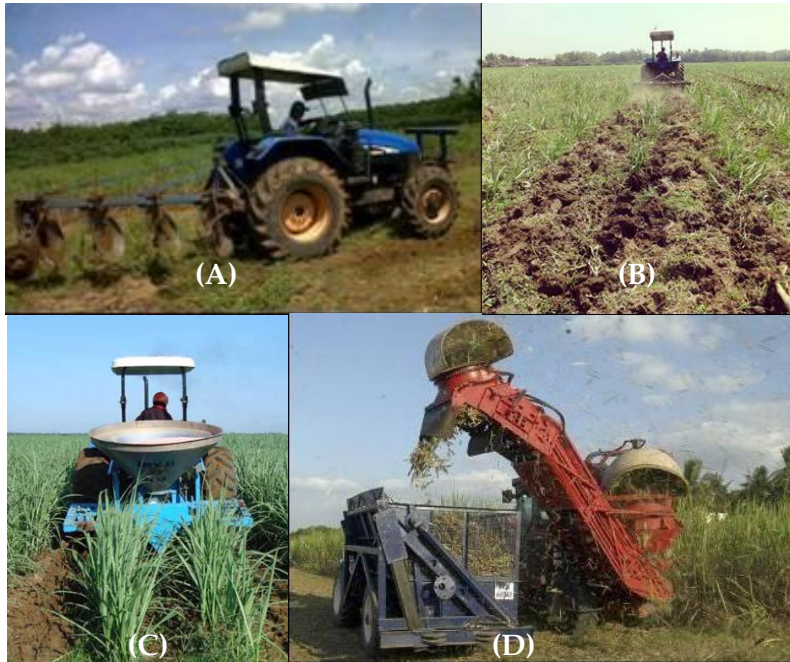
Gambar 4. Mesin pengolahan tanah (A), Mesin penyiangan (B), Mesin pemupukan (C) dan mesin pemanen tebu (D)
