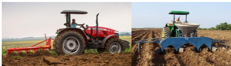
Gambar 5. Pengolahan tanah (kiri), pembuat alur tanam serta pemupukan (kanan)
