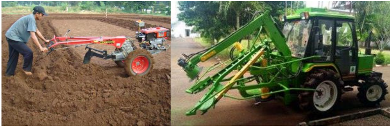
Gambar 3. Traktor tangan untuk mengolah tanah (A) dan mesin pemanen tebu (B)
