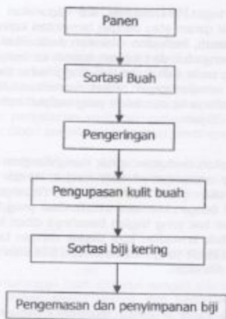
Gambar 1: Skema proses pengolahan kopi Robusta dan Arabika secara kering
