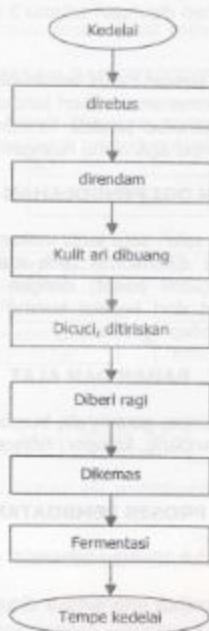
Gambar 3. Diagram alir pembuatan rempe
