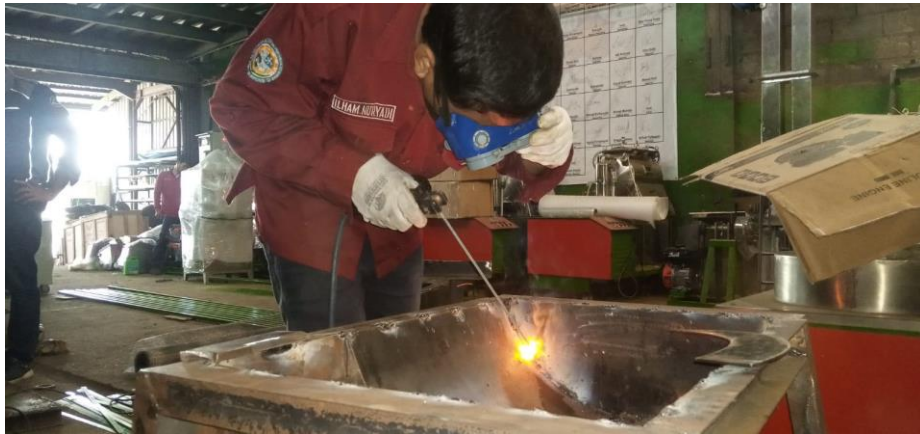
Gambar 6. Proses Pembuatan Rangka Mesin Sumber: PT. Bahagia Jaya Sejahtera, 2022
