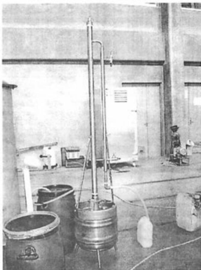
Gambar 6. Destiller tipe packing bed (Alat di Balai Besar Pengembangan Mekanisasi Pertanian).
