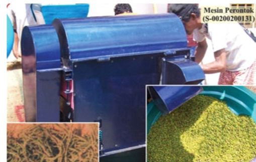
Mesin perontok buah lada kapasitas 650 kg/jam
