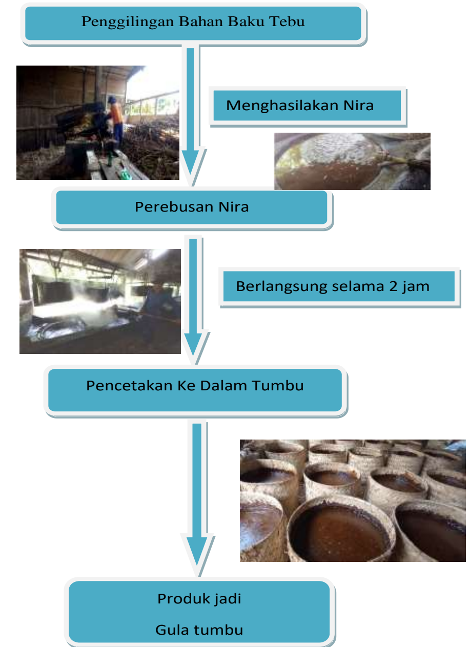
Gambar 1. Bagan proses pembuatan gula tumbu
