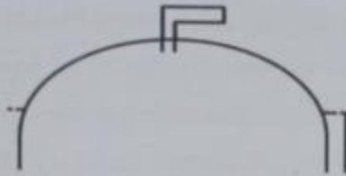
Gambar 14. Pipa Pengeluaran Pada Kubah Digester
