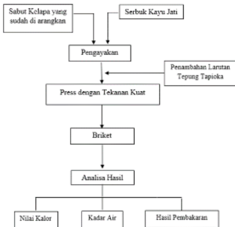
Gambar 25. Proses pembuatan briket serbuk sabut kelapa. Sumber: Haliza dan Saroso, 2022.
