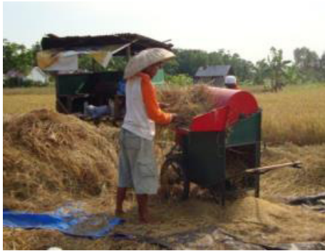
Gambar 8. Penggunaan mesin perontok padi dengan sistem throw-in di lahan pasang surut (Dok. Koersrini, Balittra)
