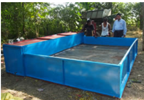
Gambar 9. Alat/mesin pengering tipe box dryer (Dok . http://www.google.com )
