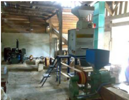
Gambar 11a. Mesin giling single-pass untuk mengupas kulit gabah menjadi bpk (Dok. http://www.google.com )
