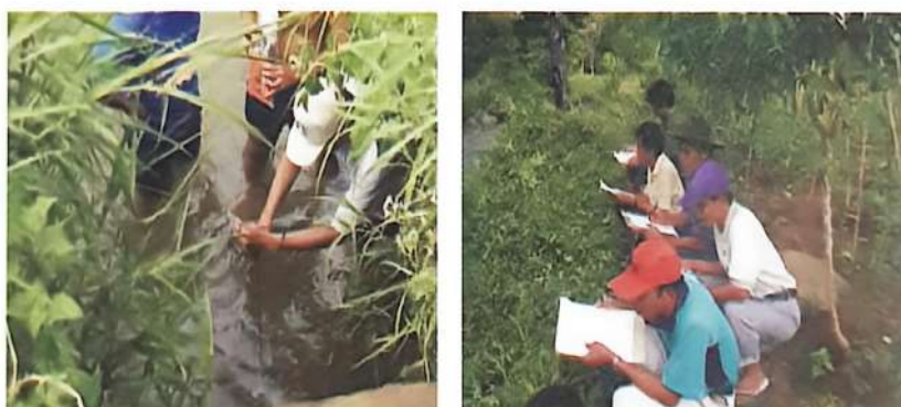
Gambar 22. Pengukuran kecepatan aliran dengan current meter propeler dan mencatat data hasil pengukuran current meter
