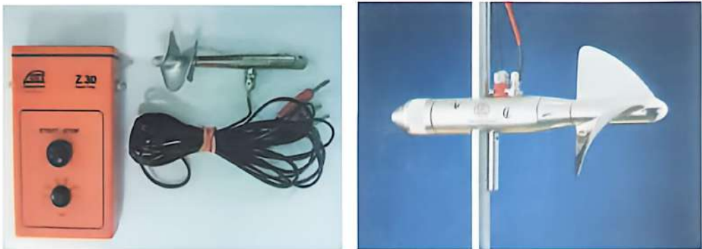
Gambar 11. Current meter tipe propeler (integrator dan propeler/baling-baling).
