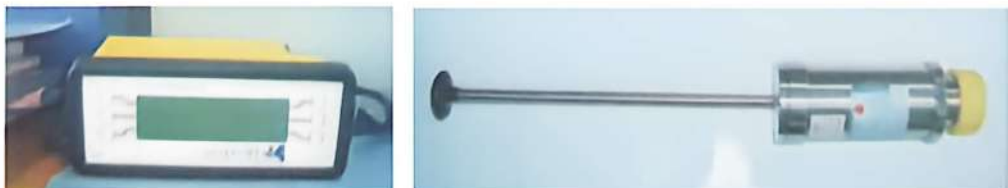
Gambar 12. Current meter tipe magnetik (integrator/control display unit (CDU) dan sensor).
