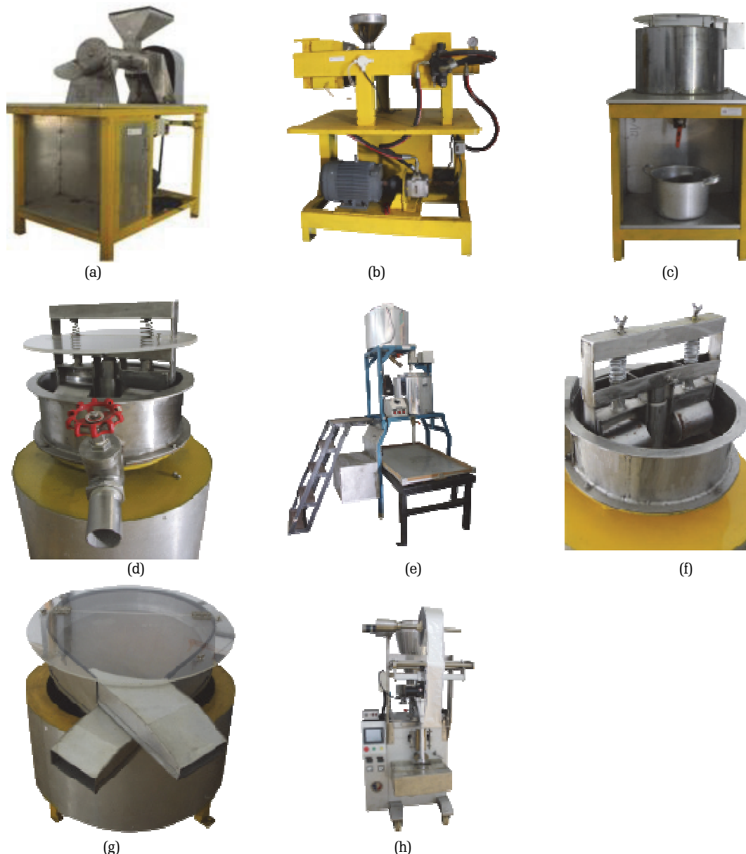
Gambar 2. Mesin pengolahan cokelat dan bubuk kakao yang terdapat di cocoa processing room : (a) mesin pemasta kasar, (b) mesin pengempa lemak, (c) mesin refiner , (d) mesin conching , (e) mesin tempering , (f) mesin penghalus bubuk kakao, (g) mesin pengayak bubuk kakao, dan (h) mesin pengemasan sachet
