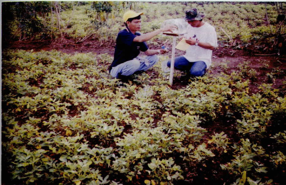
Pemasangan alat pengukur suhu dan kelembababan pada ekosistem ladangan tanaman pangan
