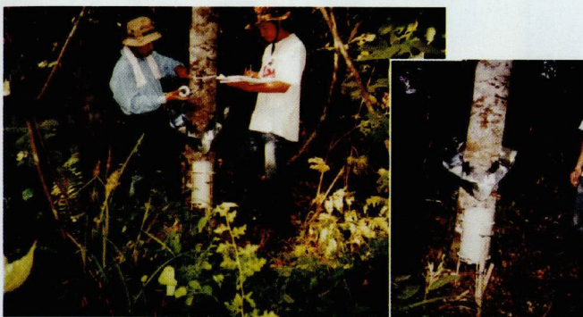
Pengukuran aliran curah hujan yang melalui batang pohon pada ekosistem hutan sekunder
