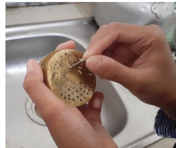
Gambar 17. Pembersihan Die Extruder
