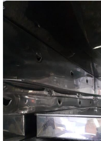
Gambar 21. Lubang Sirkulasi Pengering
