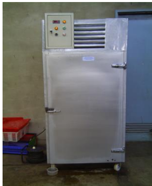
Tampak depan chiller karkas
