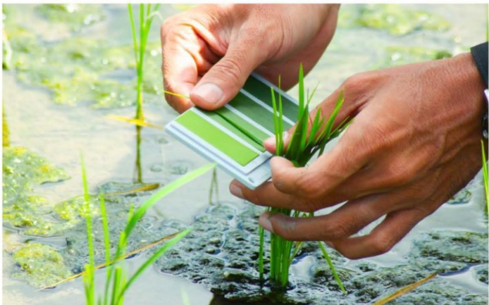
Gambar 9. Cara pengukuran dengan bagan warna daun (BWD)
