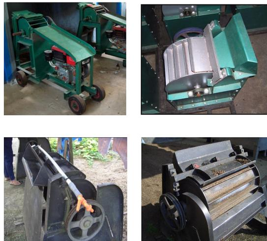
Gambar 1. Tipe dekortikator yang tersedia di daerah pengembangan rami
