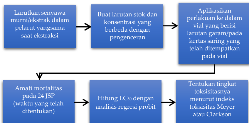
Gambar 7. Alur pengujian toksisitas metode BSLA
