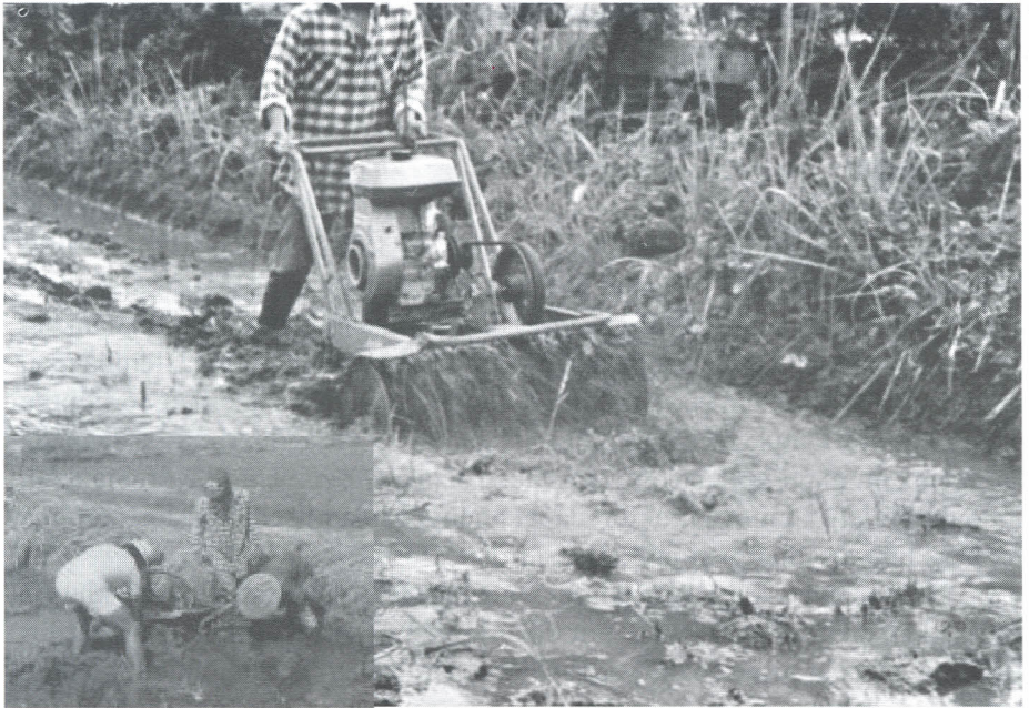
Gambar 4.7. Penggunaan traktor kura-kura untuk melumpurkan sawah yang sudah digenangi dan traktor kura-kura terperosok (inset).
