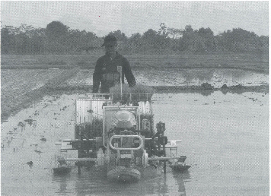
Gambar 5.7. Penanaman bibit padi menggunakan mesin tanam bibit padi Indo Jarwo Transplanter (Dok. BBP Mektan)
