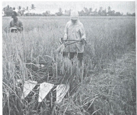
Gambar 8.7. Panen menggunakan alat panen reapper di lahan P. surut Handil Manarap
