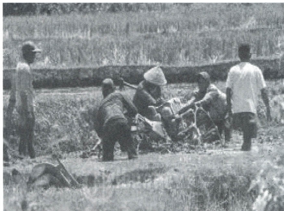
Gambar 4.11. Traktor terperosok pada lahan berlobang dan daya sanga tanah rendah
