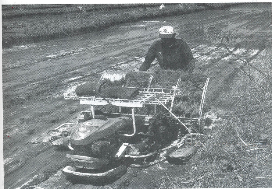
Gambar 5.5. Mesin tanam bibit padi sistem tegel di lahan pasang surut
