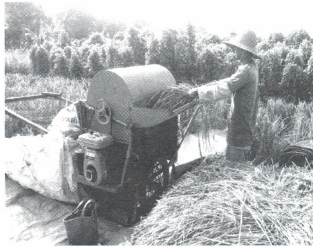
Gambar 9.3. Perontokan dengan power thresher (Dok. Umar/Balittra)
