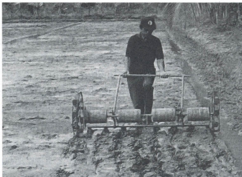
Gambar 5.1. Atabela tipe drum dengan 8 penjatuhan, kapasitas kerja 8 jam/ha
