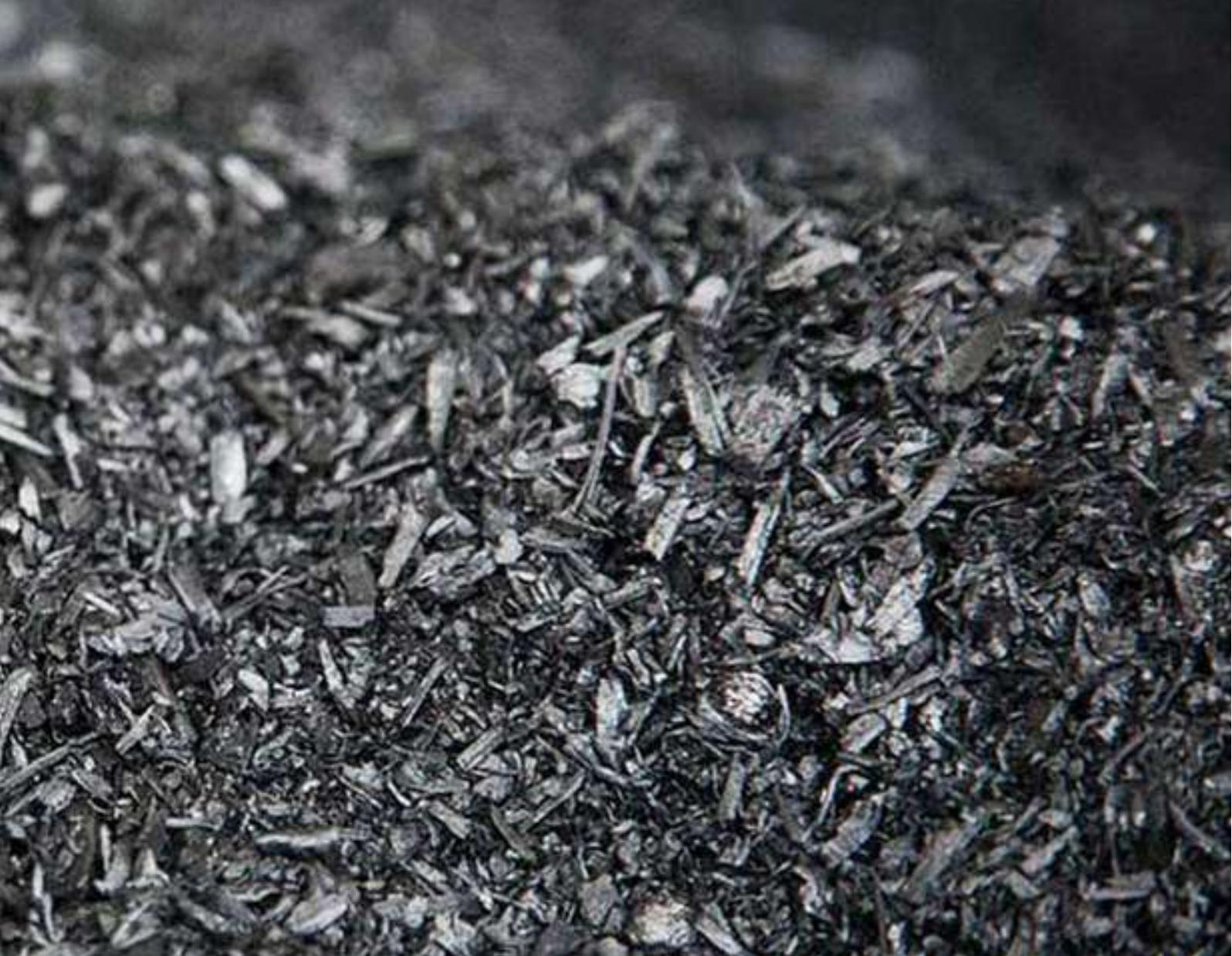
menjadi arang setelah sekam di bagian terluar terlihat menghitam dan asam yang ke luar dari cerobong makinsedikit.
