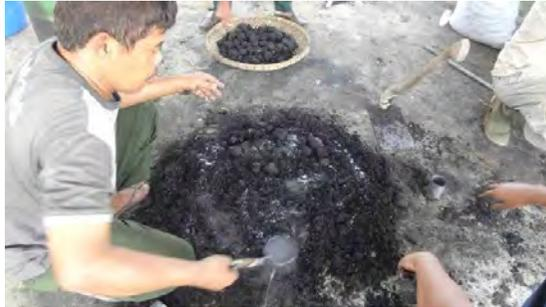
Alat pencetak dapat dibuat secara sederhana dari pipa besi, atau dibuat khusus dengan tenaga hridraulis.
