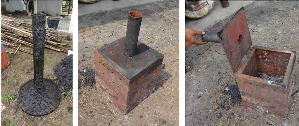
Asap yang terbentuk selama proses pembuatan arang limbah organik dapat dibuat menjadi asap cair. Caranya adalah dengan mendinginkan asap dengan memasukkan pipa asap ke dalam drum kedua yang berisi air. Pipa pendingin dapat dibuat dengan sangat sederhana seperti gambar berikut.
