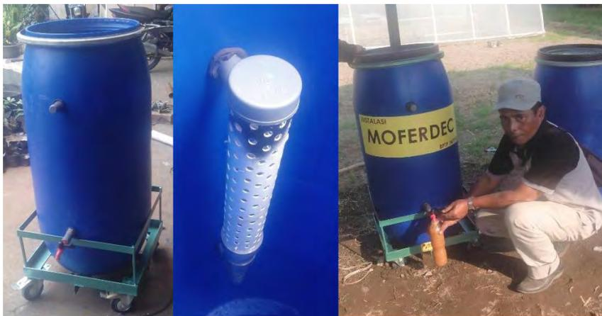
Instalasi drum pembuatan MOL juga dilengkapi dengan roda sehingga dapat dipindahkan dengan mudah dan ringan. Selain itu keunggulan dari instalasi drum MOL ini adalah adanya mekanisme penyaringan otomatis dan lebih praktis karena pemanenan MOL cukup dilakukan lewat kran.
