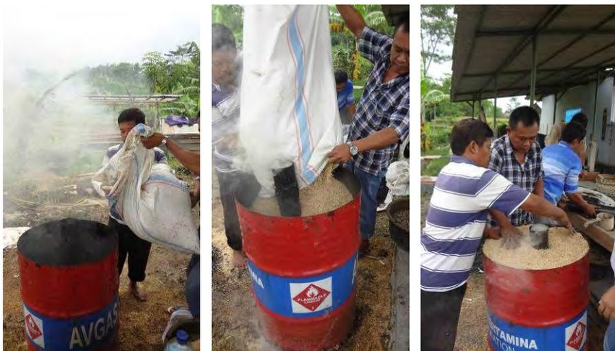
Setelah drum penuh, drum ditutup rapat dengan penutup yang tersedia. Usahakan asap hanya keluar dari cerobong asap. Apabila ada kebocoran asap dari bagian bawah atau atas drum, tutup kebocoran dengan tanah/pasir/bahan lain hingga kebocoran teratasi.
