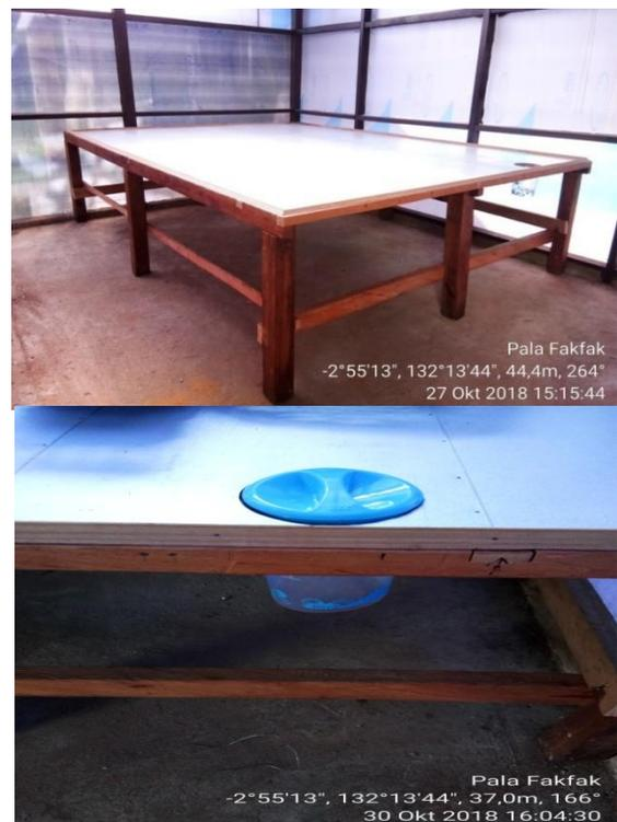
Gambar 4. Rak jemur fuli setelah modifikasi dilengkapi dengan lubang pengumpulan fuli
