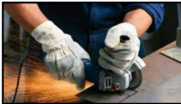
Gambar 2.10 Proses pemotongan dengan mesin gerinda (Sumber: https://blog.situansan.com/batu-gerinda-fungsi-dan-jenis )
