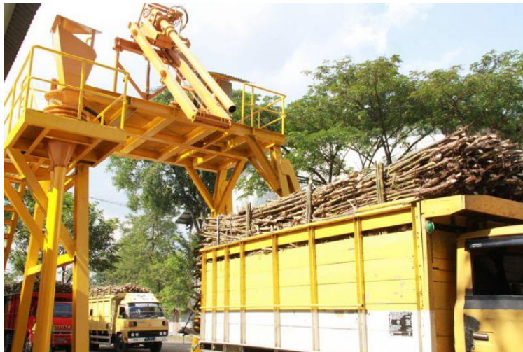
Gambar 6. Pengambilan sampel pada truk yang mengangkut tebu
