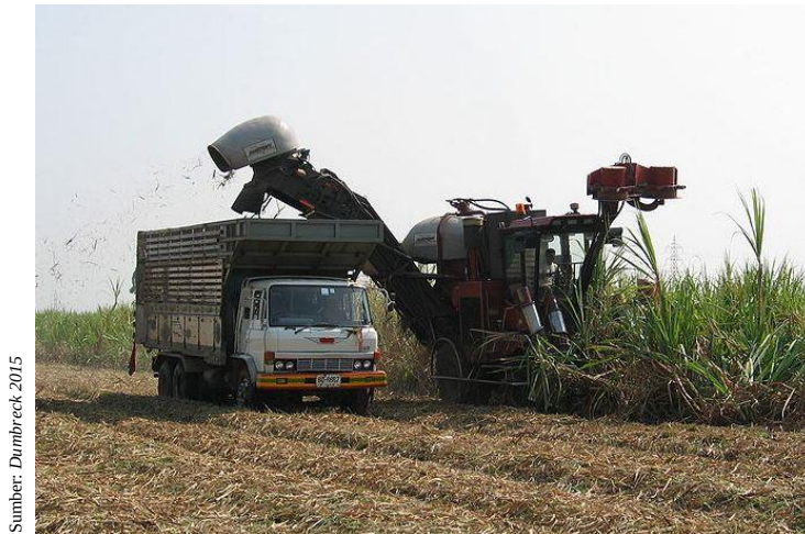
Gambar 4. Tebang muat angkut tebu menggunakan mesin panen dan truk
