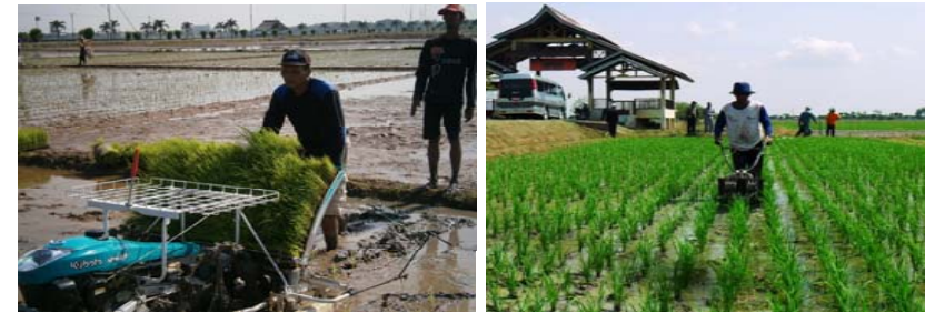
Gambar 28. Kegiatan tanam bibit padi dengan mesin transplanter dan penyiangan padi sawah dengan mesin power weeder BBP Mektan
