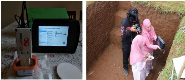
Gambar 32. Smart Soil Sensing Kit dan penggunaan langsung untuk deteksi di lapangan
