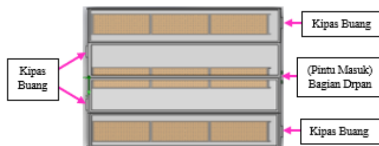
Gambar 4.62. Posisi kipas buang skenario 5
