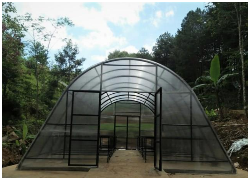
Gambar 2.9. Solar home dryer tipe dome (sumber: http://dispertan.cilacapkab.go.id/ )
