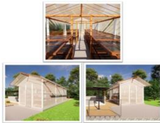
Gambar 2.7. Pengering buatan solar dryer (Kusmayati, et al. , 2021)
