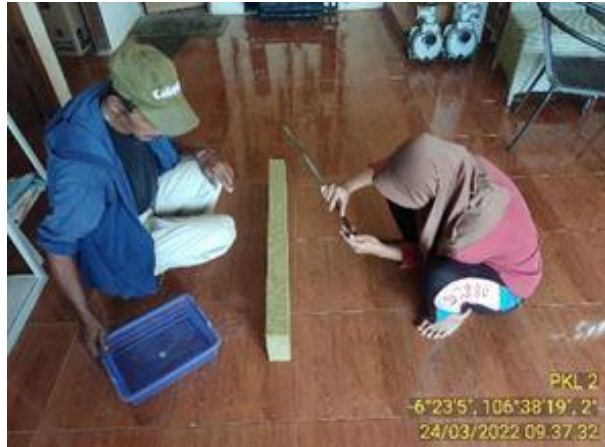
Gambar 4. 9. Memotong rockwool dengan ukuran 3x3 cm (Sumber : Dokumen Pribadi)
