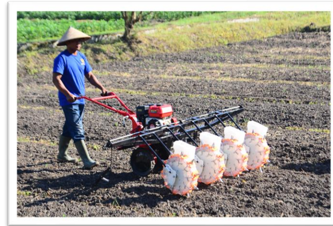
2 - 4 baris seeder → dengan / tanpa penutup lubang tanam otomatis
