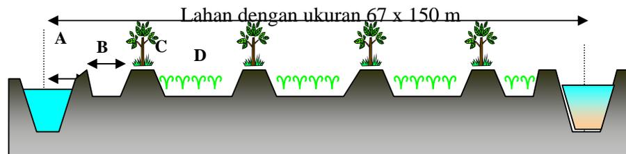
Gambar 2. Diagram pembagian surjan pada luasan satu hektar dengan ukuran 67 m x 150 m. Keterangan : A = Jarak dari Saluran kuarter + galengan pembatas 2 m. B = Jarak dari galengan pembatas ke Surjan I = 3 m. C = Lebar Surjan = 3 m. D = Lebar tabukan = 15 m
